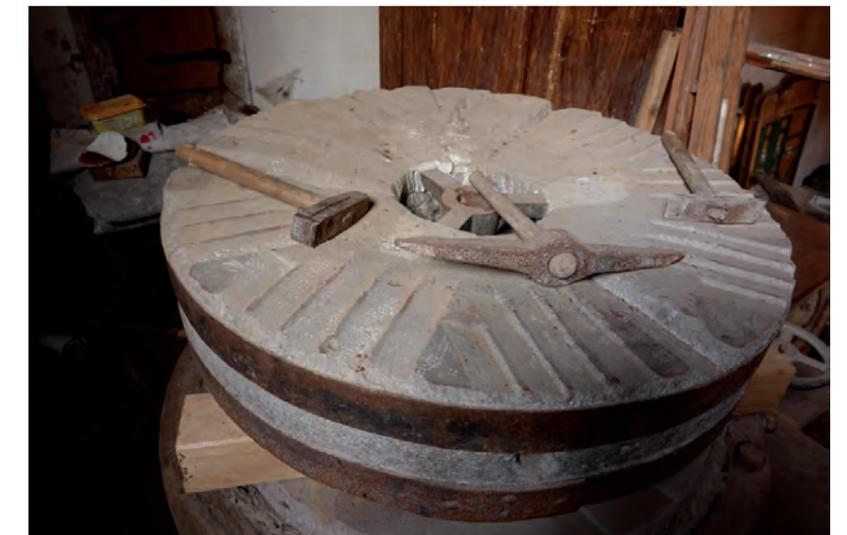
Mühlstein vom Roggengang. Werkzeug links: Kieshammer zur Oberflächenbearbeitung Mitte: Zweispitz für die Luftfurchen rechts: die Bille zur „Schärfung“
