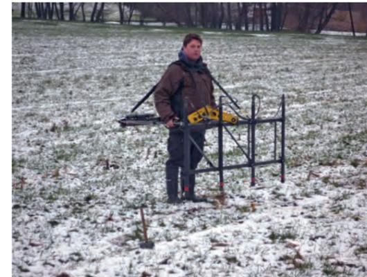
von rund 1,0 m unter Geländeoberkante, in Ausnahmefällen bis 2,0 m, erfasst werden können.
