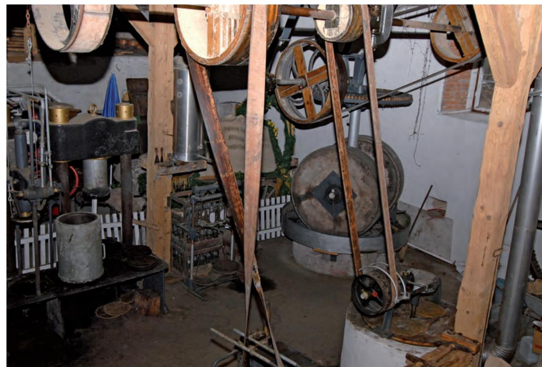
Die Ölmühle in Maihingen aus dem frühen 20. Jh. zeigt wie die in Oberdorf (v.l.n.r.) eine hydraulische Presse, die Flaschenfüllung, den Kollergang, die Wärmepfanne, die Hydraulik, (nicht mehr zu sehen:) Mühle mit Walzen (statt Kollergang) und Motor; darüber die (hier elektrisch betriebene) Transmission. Foto Georg Hopfenzitz
